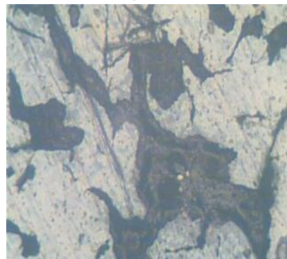
(d) 2.5 % Cr, annealed at 900 0 C
