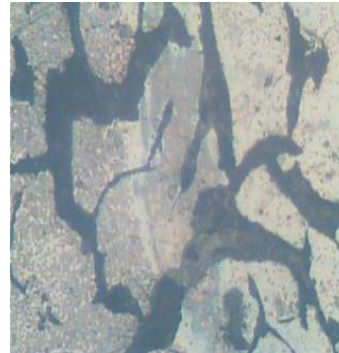
(d) 2.5% Cr, annealed at 850°C
